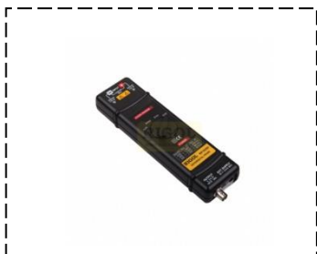
7kV/50MHz 高壓差動探棒
